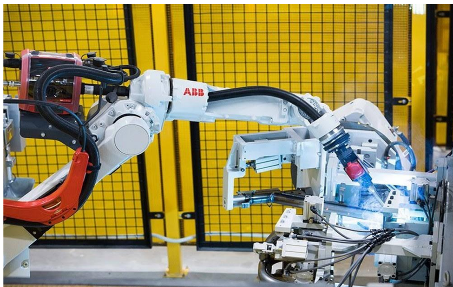
Robot hàn Khung xe được Weldcom lắp ráp tại nhà máy Vinfast
