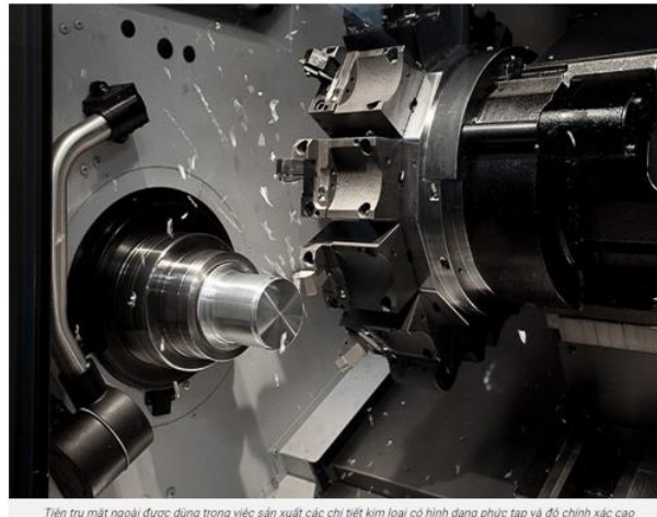
Tiện trụ mặt ngoài được dùng trong việc sản xuất các chi tiết kim loại có hình dạng phức tạp và độ chính xác cao
