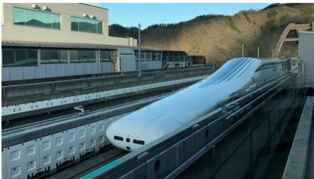
Tàu đệm từ siêu dẫn L0 trên đường chạy thử nghiệm tại Nhật Bản.
